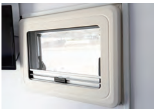
アクリル2重RV窓には、網戸とスクリーンカーテンが付いています
