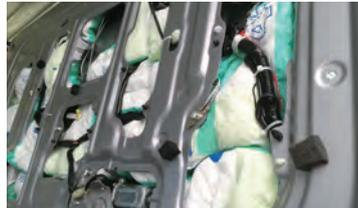
車体全体に断熱材を挿入加工することで外気温を遮断し、年間を通し快適にお過ごしいただけます。
