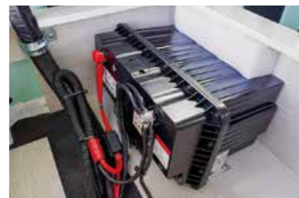
100Aのリチウムイオンバッテリーが動力源です。
