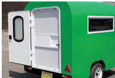
標準仕様は、横幅80cmの網戸付き大型エントランスドア。
