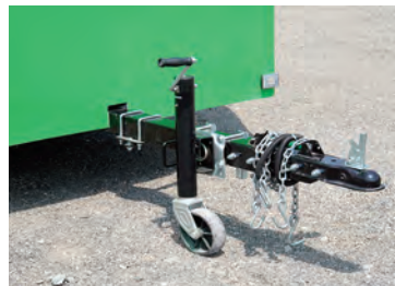
慣性ブレーキは、2インチのカプラーで接続します。電装は7ピンソケット対応です。
