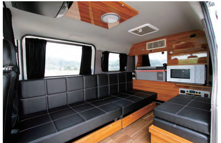
対面のソファベッドと一番奥(ハッチゲート側)にギャレを配置し、手の届く範囲で操作ができるようにしました。勿論天井やサイドには断熱材が入っています。
