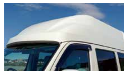
車両に合わせて設計されたFRP一体成形
