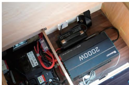
リビングシート下に、増設可能なリチウムイオンバッテリー、インバーター、走行充電器、MPPTコントローラー、AC充電器等が設置されています。
