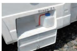
サイドスクートの収納庫。FF灯油ヒーターのタンクが設置してあります。
