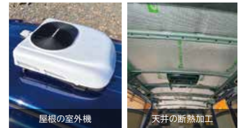
屋根の室外機
