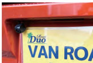
バックカメラで後方の安全確認。
