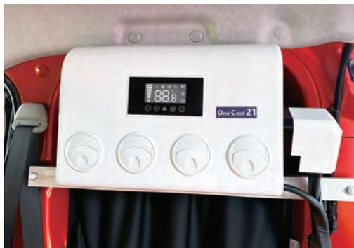
12Vエアコン One Cool 21小型で冷房能力のある12V仕様の車専用エアコンが標準装備。
